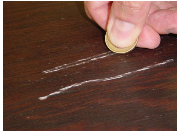
Abb. 2: Oberfläche mit schlechter Haftung nach Coin-Test
