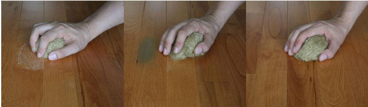
Abb. 7: Oberflächenkratzer auf einer UV-Oberfläche mit normalem UV-Überzugslack
