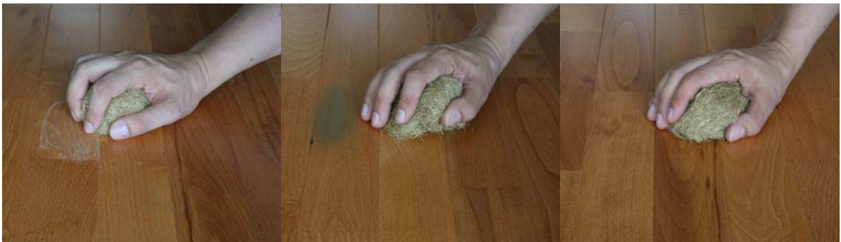
Abb. 7: Oberflächenkratzer auf einer UV-Oberfläche mit normalem UV-Überzugslack
