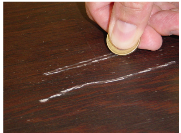
Abb. 2: Oberfläche mit schlechter Haftung nach Coin-Test
