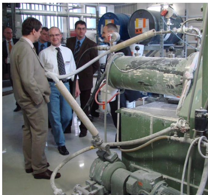
Der Grundstoff muss fein gemahlen sein: Im Vordergrund eine Perlmühle des bayerischen Herstellers Netzsch Feinmahltechnik.
